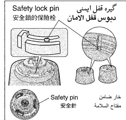
هذا القفل معد لمنع الخلط من التشغيل عند عدم وضع وعاء الخلط بشكل صحيح. لا تدفعه بواسطة أي قضيب. عند الضغط على مفتاح السلامة المثبت خلف كل وعاء أثناء التجميع، فلن يعمل المотор.
